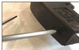
پیچ رگلاژ منگنه برای انواع مختلف پلاک تنظیم پیچ رگلاژ منگنه توسط آچار آلن 4mm
