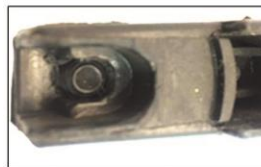
پیچ رگلاژ منگنه برای انواع مختلف پلاک تنظیم پیچ رگلاژ منگنه توسط آچار آلن 4mm
